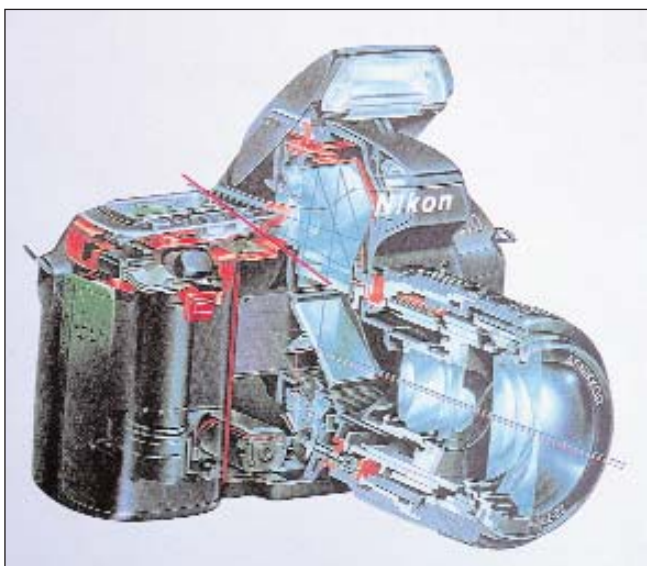
Рис. 5. Устройство зеркальной камеры с системой автоматического управления вспышкой
